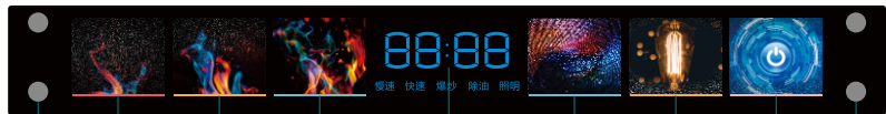
体感感应1 慢速键 快速键 爆炒键 时间/档位显示 化油键 照明键 开/待机键 体感感应2
